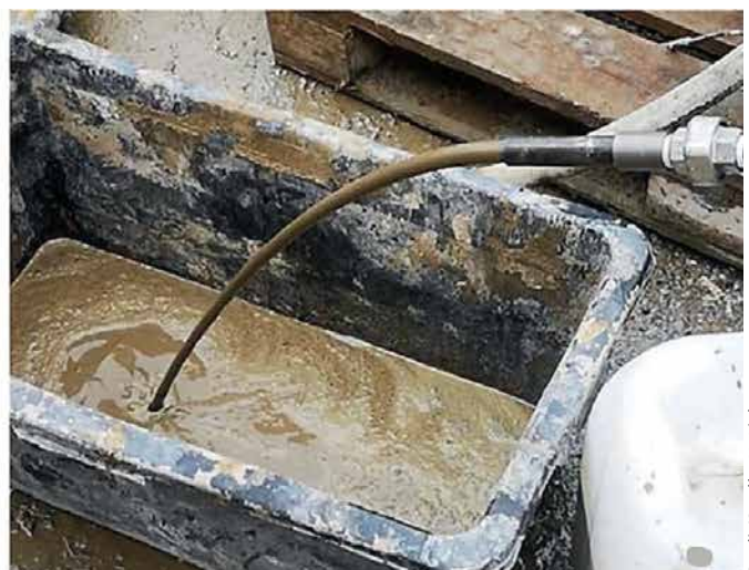
1 Free discharge of standard cement suspension (left), free discharge of a combined cement-polyurethane suspension (right) Freier Auslauf von Standard-Zement-Suspension (links), freier Auslauf einer kombinierten Zement-Polyurethan-Suspension (rechts)
